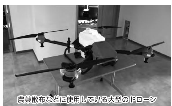
農薬散布などに使用している大型のドローン
